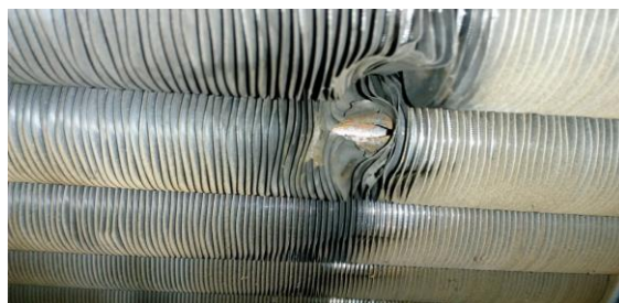
Рисунок 1 - Фото разгерметизации трубок
