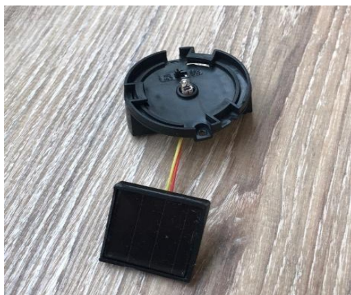
Рисунок 1 – Система электроснабжения – солнечная электростанция
