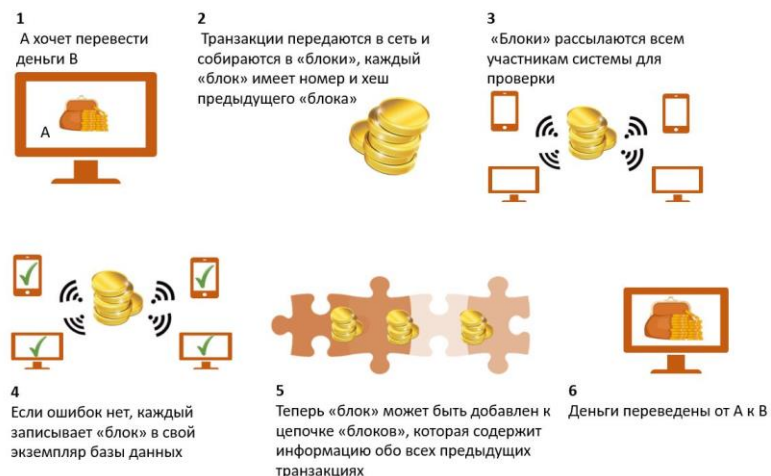
Рисунок 4 – Как работает система блокчейн (на примере криптовалюты)
